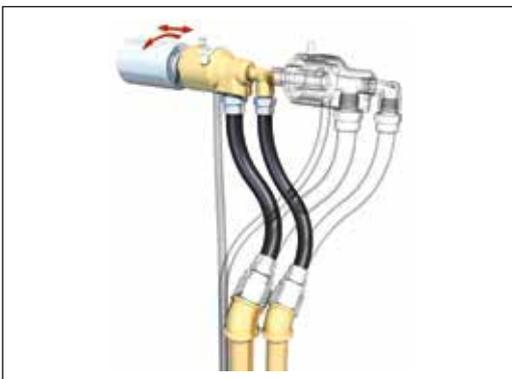
Lorsque les joints tournants sont installés sur des arbres de machine ayant un mouvement oscillant (axial), alors les flexibles ne doivent avoir aucune tension dans les deux positions extrêmes.
