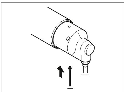
Les joints tournants sont pourvus de trous de drainage.
