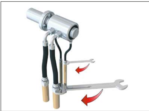
Fig. 4: Flexibles dispuestos a 90°
