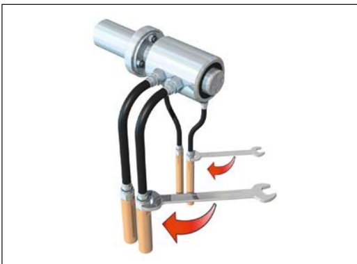
Fig. 5: Conecte los flexibles con conexiones rectas
