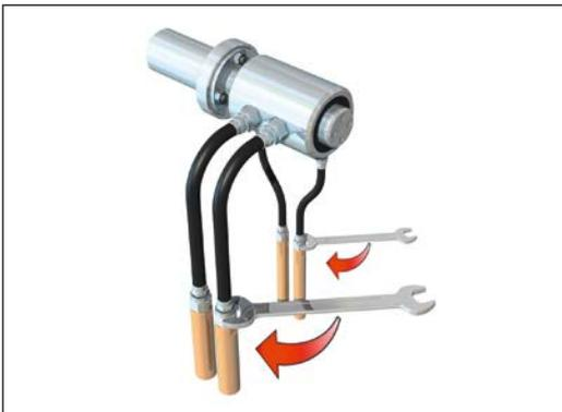
Fig. 5 : Monter les flexibles avec des raccords droits
