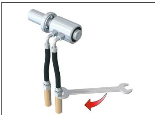
Abb. 6: Schläuche mit 90° Bogen anschließen
