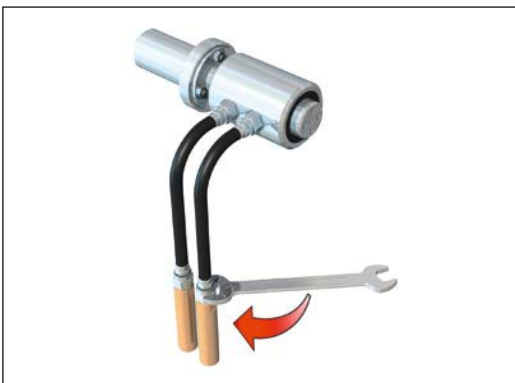
Abb. 7: Schläuche mit geradem Anschluss anschließen
