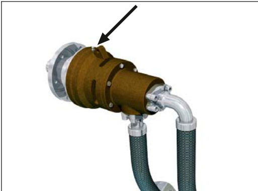
Abb. 8: Fettpresse aufsetzen und schmieren
