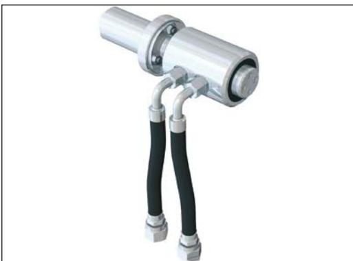
Use tubos flexibles para conectar la junta rotativa. Los flexibles evitan que se transmitan cargas laterales a los rodamientos de la junta.
