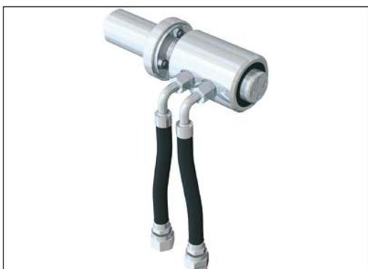
流体を供給する配管はフレキシブルホースを使用していただくことが重要で、運転中に回転ユニオンのベアリングに横方向の荷重がかからないようにしてください。
