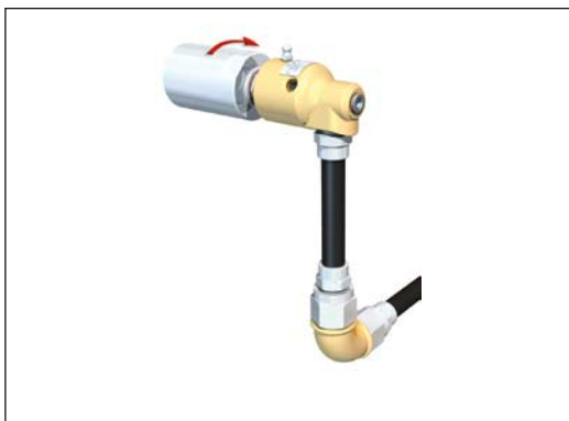
図 7: ホースが 90 度に曲がる接続
