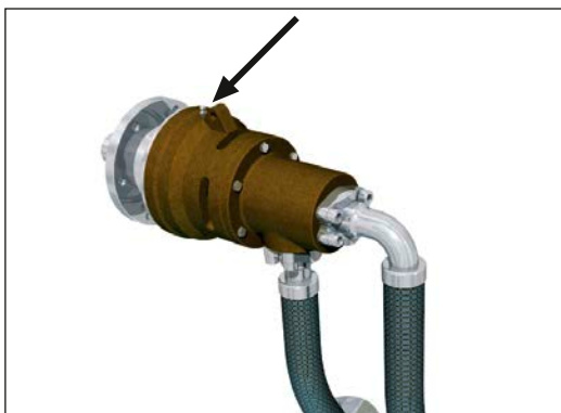
Rys. 8: Przystaw smarowniczkę do gniazda smarowego
