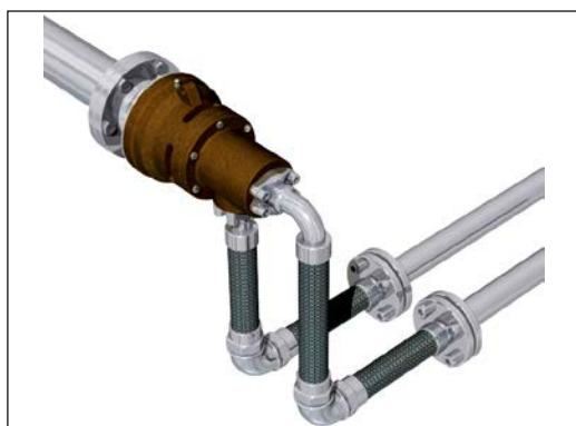
Rys. 5: Przewody giętkkie ułożone pod kątem 90°
